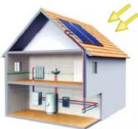
热水温度界定在40~60摄氏度的区间为宜，低了可能取暖效果很差，高了可能使采暖系统和散热系统老化加快。辅助能源的选择也要考虑用户使用的便利性与成本，有的地方适宜用电，而有的房子只能用燃气，有的农村用户选用沼气或生物质锅炉等。设备的成本、后期费用、寿命与故障率，都会影响太阳能供暖的效率。辅助能源是否节能、节能多少、与太阳能是否完美结合等，都是供暖系统成功与否的基础。从实践来看，太阳能供暖系统一个采暖季消耗2000~3000度电，是大部分用户认可的耗电量。太阳能供暖技术的核心在于计算机智能控制系统和整套系统的优化设计。计算机智能控制系统负责对太阳能集热器、辅助能源、水箱、循环系统进行综合管理，对提高太阳能利用率、降低辅助能源消耗的作用最大。
